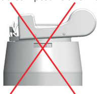
Ill. 6: Montage non conforme du module EDC
