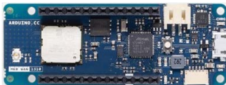
Figure 139: Arduino MKRWAN 1310 : Microcontrôleur ATMEL 32 bits + Module CMWX1ZZABZ
