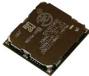
Figure 134: Module intégrant une Stack LoRaWAN et un transceiver LoRa
