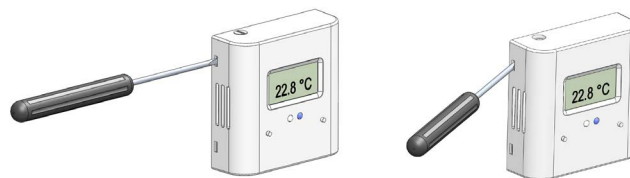
Abb. 2: Demontage von der Rückenplatte
